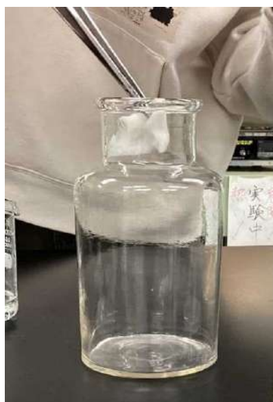
【写真 6】 酢酸水溶液に浸した脱脂綿を入れ、集気している様子
