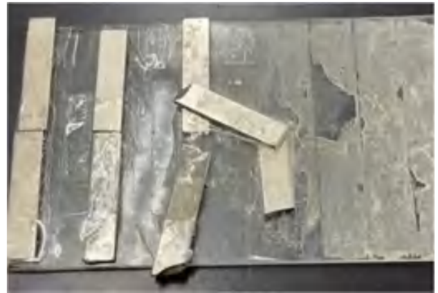
図6 実験③で作成した装置のネオジウム磁石が互いに反発しあい、壊れたもの
